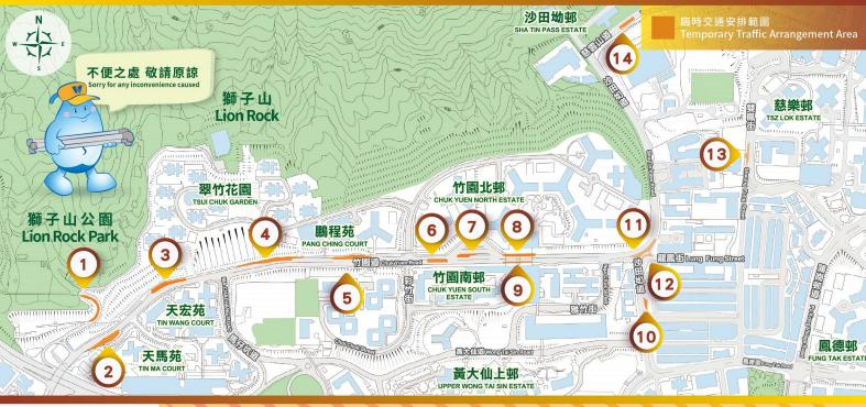
我們正於竹園道、沙田坳道、龍鳳街、雙鳳街及慈雲山道進行水管敷設工程,目的是連接搬遷後的配水庫至現有的供水網路。目前在3、4、8、9、 12、13及14地點正進行明坑挖掘,而5、6及7地點正在進行側向支撐系統的挖掘和安裝,為將來無坑挖掘作準備。
